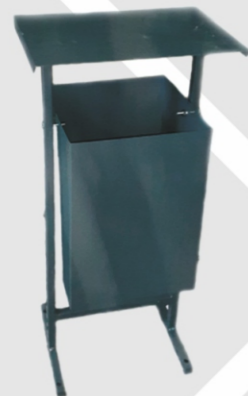
Урна уличная ОП-2199 Изготовлена из стального листа, толщиной 1,5 мм. и стальной трубы 20x20x1,5 мм. Покрытие - краска порошковая RAL 7024. В комплект входят анкерные болты M10x100 (4 шт) для крепления к прочному основанию. Габаритные размеры HxLxB (мм): 850x340x270 Объем 30л.
